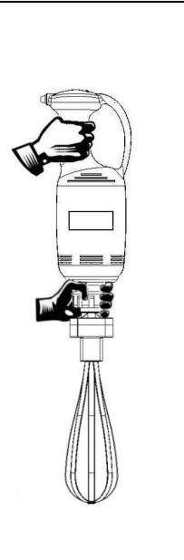
**▲ ОПАСНОСТЬ – ВНИМАНИЕ:** Запрещается приближать руки или другие части тела к зоне, в которой находятся венчики насадки, когда насадка с венчиками подсоединенна к моторному блоку. Чистить насадку только после того, как она снята с моторного блока.
