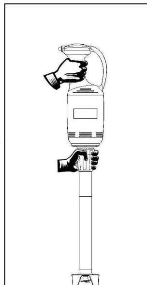
**▲ ОПАСНОСТЬ – ВНИМАНИЕ:** Запрещается приближать руки или другие части тела к зоне, в которой находится нож смесителя, когда смеситель подсоединен к моторному блоку. Чистить насадку только после того, как она снята с моторного блока.
